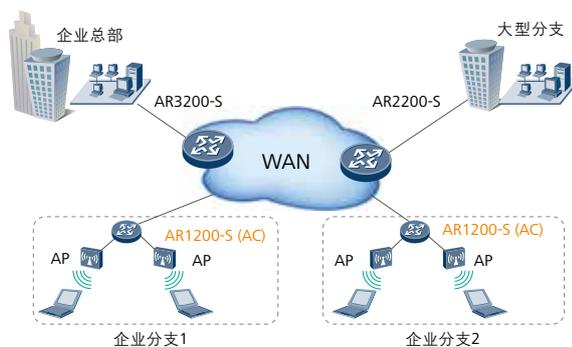
AR1200-S系列企业路由器集成了AC(Access Controller, 无线控制器)功能，可对无线局域网中的AP(Access Point, 接入点)进行控制和管理。AR支持丰富的认证方式和灵活的用户权限控制，能为Wi-Fi用户提供安全接入保证。同时集丰富的无线功能于一身，实现对有线无线一体化网络的集中管理，满足不同规模企业的建网要求。
